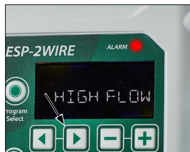
Přední panel ESP-2WIRE jednotky Alarm nadlimitního průtoku
