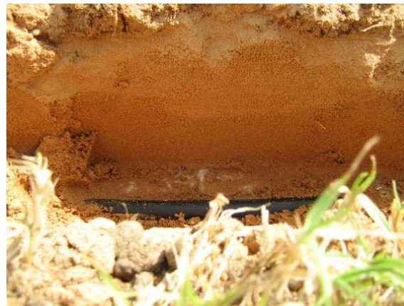
Distribuce vody cca po 30 minutách po spuštění závlahy. Testovací plocha Abu Dhabi, Sjednocené Arabské Emiráty
