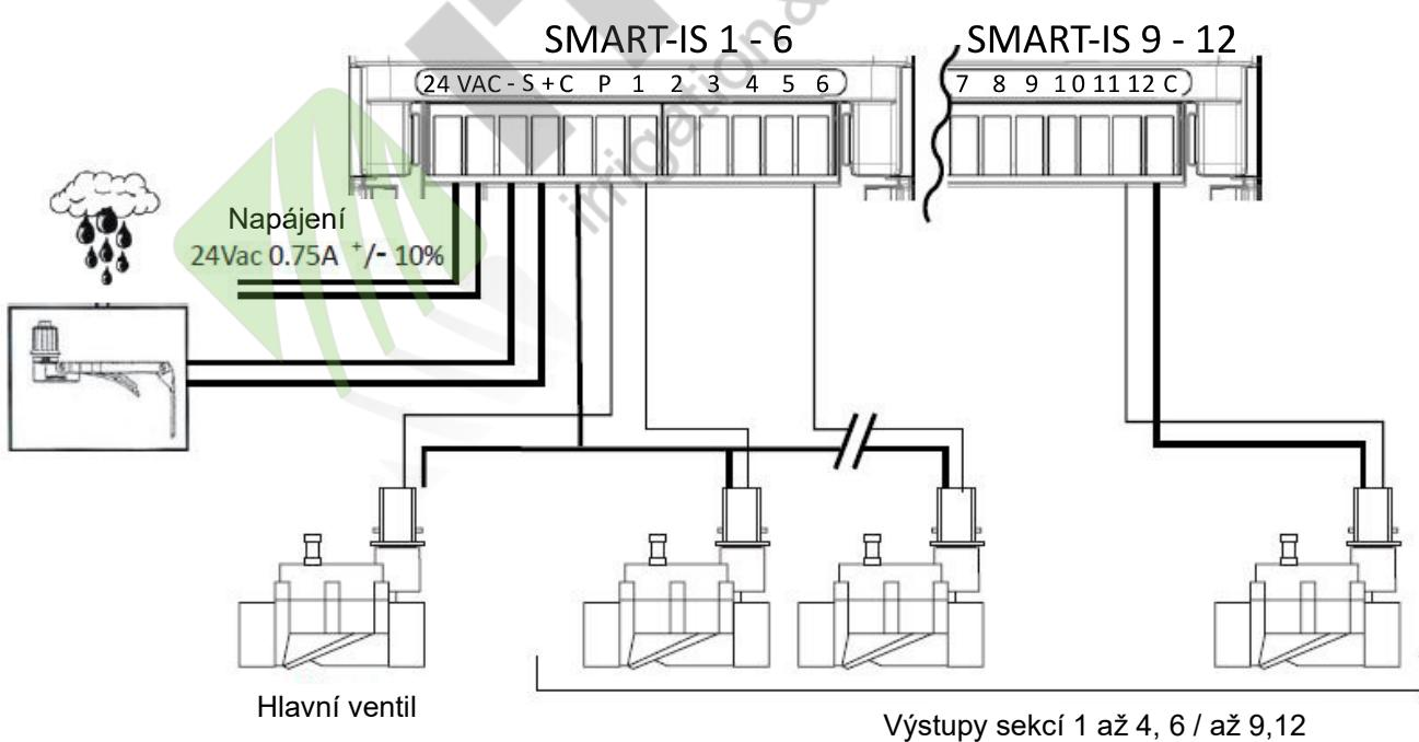
Zapojení s čidlem srážek
