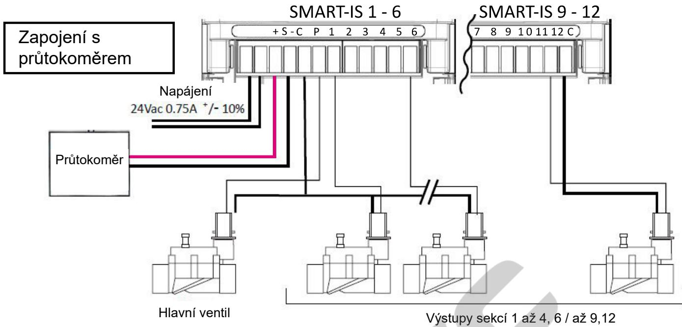
Připojte vodoměr, vybavený pulzním snímáním průtoku na výstupy - **S** + na svorkovnici ovládací jednotky. Použijte průtokoměr se suchými kontakty (bez napětí).
